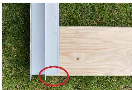
1. Nasuňte fošnu do hliníkového rohu, fošňa by mala cca 2 mm vytrčať.
